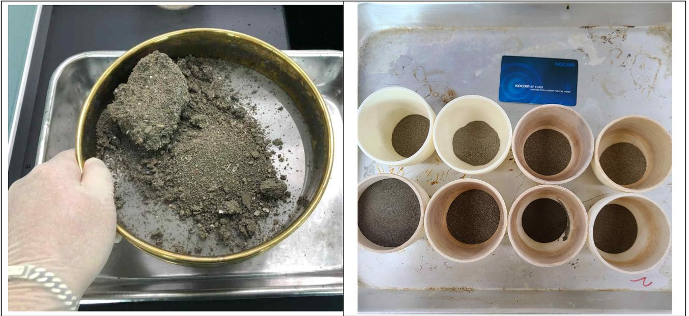
그림 19. 300 $\mu\text{m}$  거름망 분리 및 수집된 고형물
